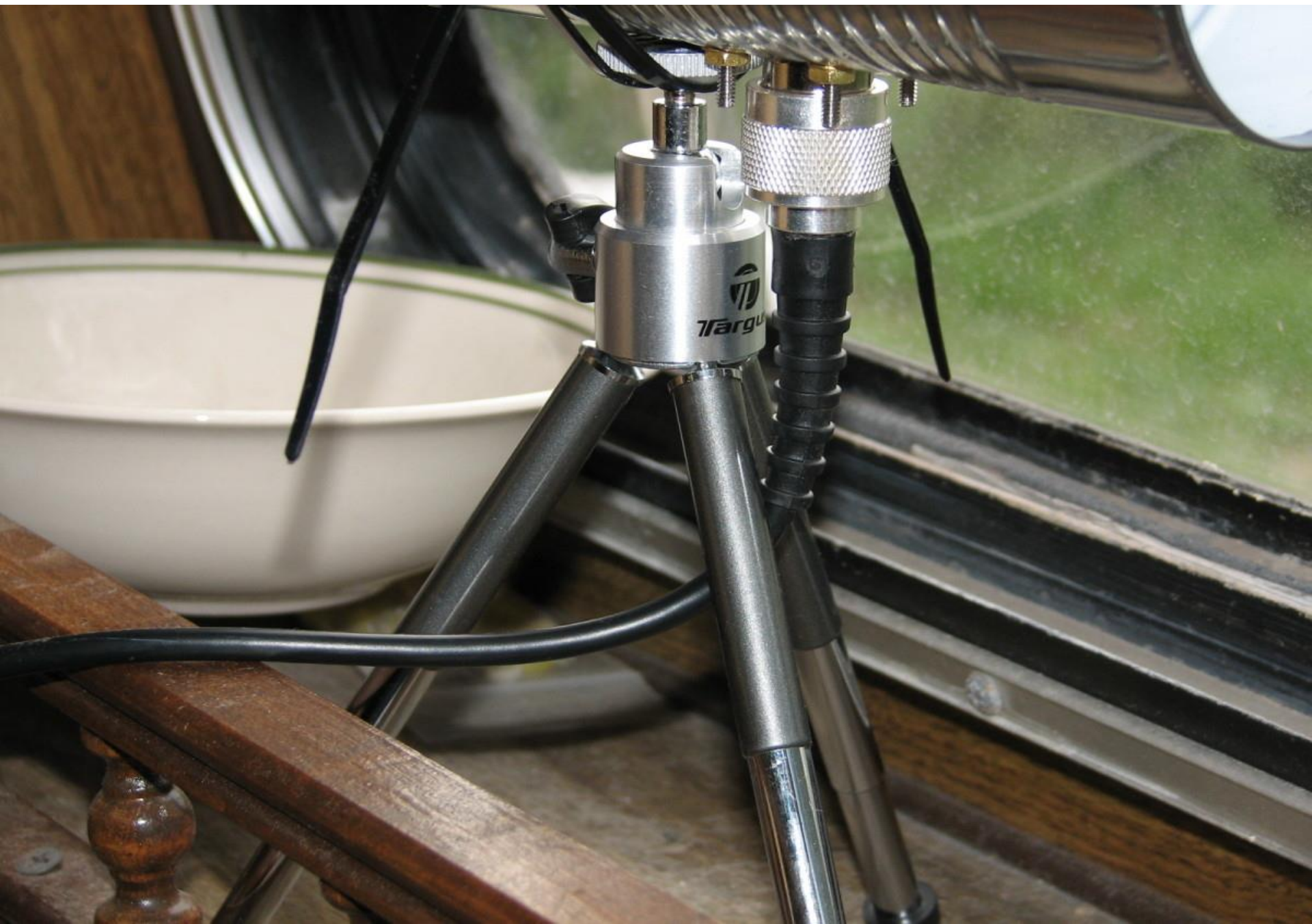
Cantenna – montagem em tripé
